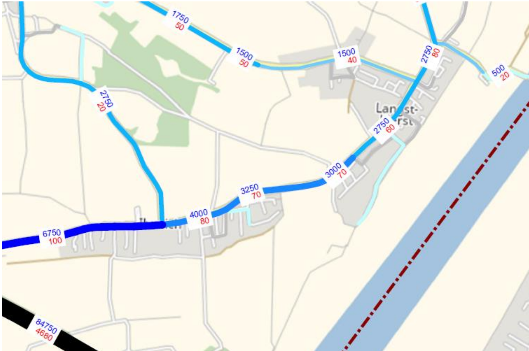
Abbildung 9: Analysefall 2021 - Darstellung der modellierten Verkehrsbelastungen in Meerbusch (Rheingemeinden Langst-Kierst & Ilverich; Kfz / 24h: durchschnittliche, werktägliche Verkehrsbelastungen, DTVw, davon Schwerververkehr in rot dargestellt)
